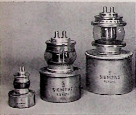
Luftgekühlte Siemens-UKW-Senderöhren RS 1021 L, RS 1001 L und RS 1031 L (von links nach rechts), wie sie in Fernsehendern Verwendung finden
